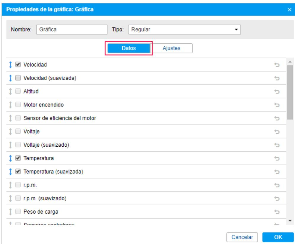
Se puede marcar dos puntos a la vez. En este caso en la gráfica se muestran dos curvas, por ejemplo, de velocidad y de revoluciones de motor. Puede haber más de dos curvas, pero solo si además del tiempo en la gráfica no haya más de dos variables. De esta manera, si a la izquierda por el eje Y va la escala de velocidad y a la derecha – la de temperatura, no puede agregarse nada
