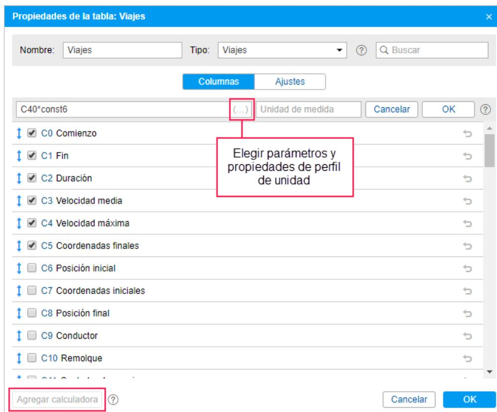
Para agregar una columna personalizada a la tabla, apriete el botón **Agregar calculadora** e introduzca la fórmula para calcular el valor de la columna. Para hacerlo, puede utilizar:
